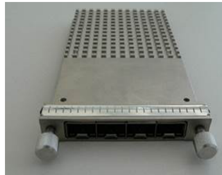
FourX converter Module con 4 puertos 10GBASE (SFP+)
