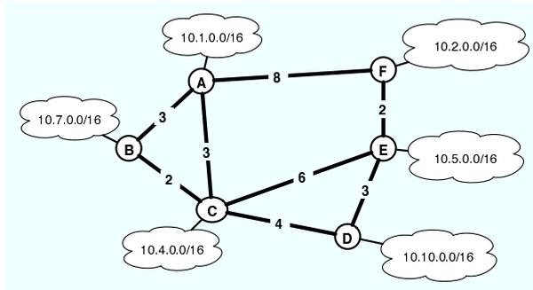
Suponga que se utiliza un algoritmo de tipo link-state para realizar el enrutamiento. En el nodo B se conoce toda la información de enlaces y nodos y se ejecuta el algoritmo de Dijkstra para obtener los caminos mas cortos desde B a cada red destino.
