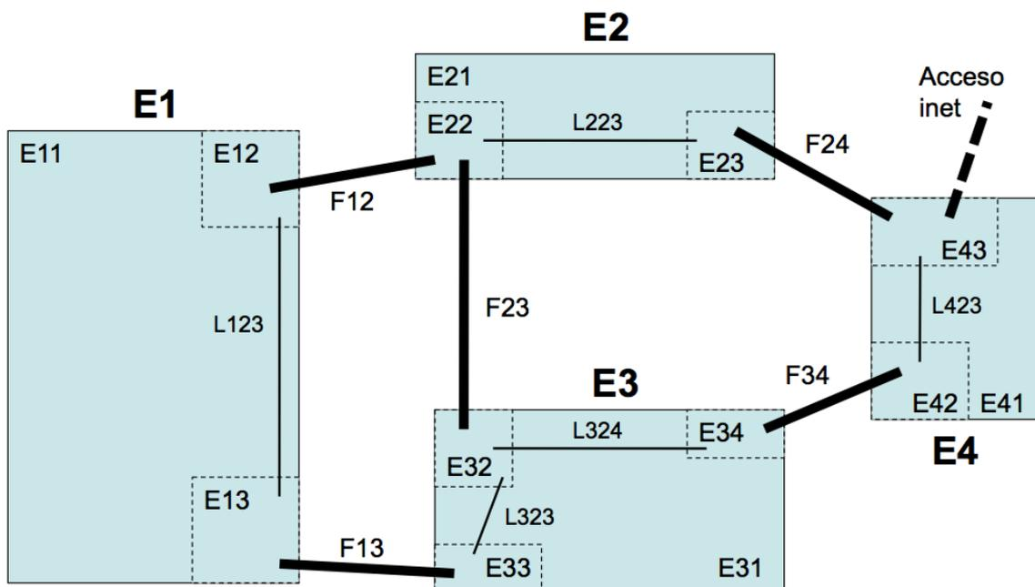
Figura 1.- Edificios y cableado de interconexión de salas
