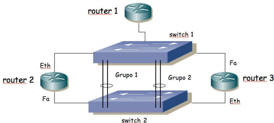
Figura 2.- Interconexión física de routers y conmutadores
