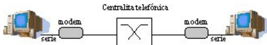
Figura 2.- Dos PCs con enlace punto-a-punto por módem
