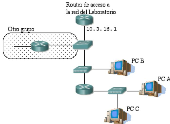
Figura 3.- Router a la red del laboratorio
