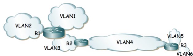
Figura 32 - Topología de nivel IP
