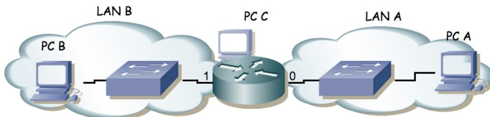
Figura 2.- Router conectado a dos redes
