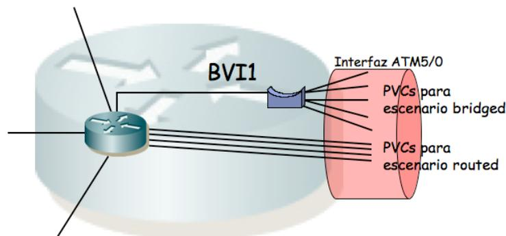
Figura 2.- Representación de los interfaces del agregador
