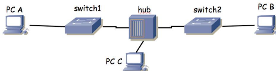
Figura 1.- 2 conmutadores interconectados a través de un hub
