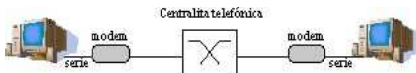
Figura 2.- Dos PCs con enlace punto-a-punto por módem
