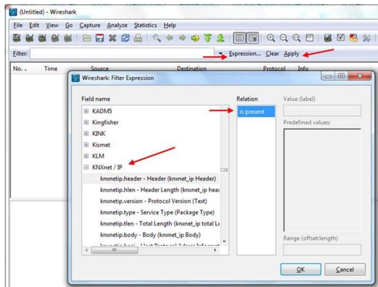
Figura 4. Configuración del filtro para mostrar los paquetes KNXnet.
