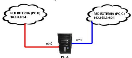
Configura los 3 equipos para simular éste escenario y activa el enrutado en el equipo PC-A. Utilizar 2 VLANs diferentes para simular las dos redes. Comprueba el funcionamiento.
